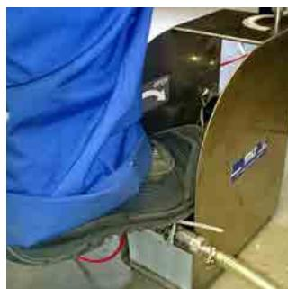
**14|** Drücken Sie das Pedal. Überprüfen Sie den Schließdruck mit dem Manometer. Lassen Sie das Pedal los, wenn Sie den gewünschten Druck erreicht haben (am Ende kann eine Pfeife von der Pumpe abgegeben werden). Öffnen Sie die Maschine, indem Sie das Pedal betätigen.
