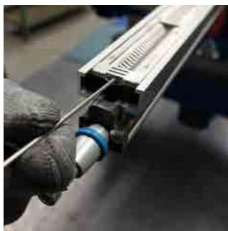
**11|** Setzen Sie den Pin ein und entfernen Sie die Pappe vom Verbinder.
