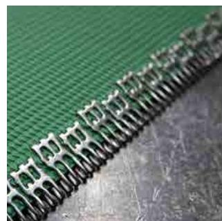
**17|** Entfernen Sie den Pin. Wiederholen Sie ab Schritt 11. Mit der anderen Seite des Gurtes.
