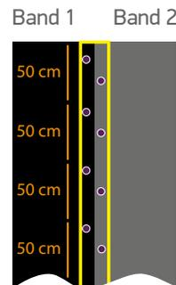
Für eine 2-Bänder Längsrichtung-Verbindung:
