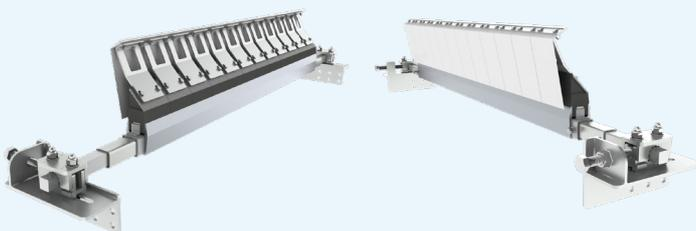
Die schwere Version **RacloFlex N-HD** wird für Bänder von 1400 bis 2200mm empfohlen; Wolframkarbid 5x10, Aluminiumprofil Blockhalterung und verstärkte Mechanik.
