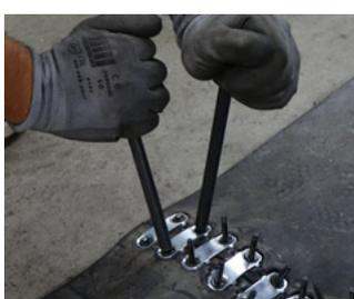
10| Brechen Sie die Enden der Schrauben mit 2 Schraubendrehern ab.
