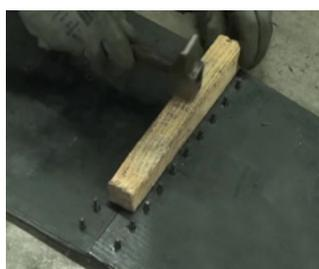
6| Drehen Sie die Schrauben tief in das Band ein. Legen Sie einen Keil zwischen die Schrauben und führen Sie leichte Hammerschläge aus.
