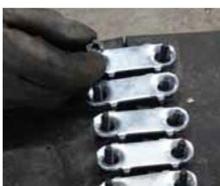
8| Setzen Sie die Muttern auf alle Schrauben.
