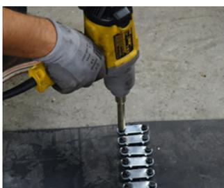
3| Bohren Sie mit dem Schraubenzieher und dem entsprechenden Stanzwerkzeug die Löcher für die Schrauben. Entfernen Sie die Befestigung und die Schablone.
