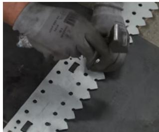
2| Richten Sie die beiden Enden des Bandes aus. Befestigen Sie die Bohrschablone an mehreren Stellen auf das Band.
