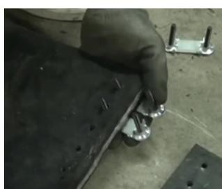
4| Drehen Sie eine Seite des Gurtes um und setzen Sie die erste Reihe der Schrauben in die Löcher ein.
