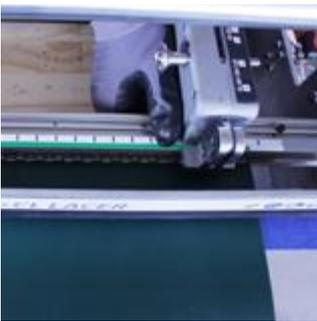
**9|** Positionieren Sie die CL L a c e r Verschlussvorrichtung im Anschlag (links oder rechts) und drücken Sie dann den Schließhebel nach vorne.
