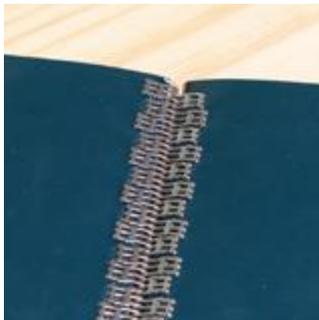
17| Zum Schluss verbinden Sie die beiden Teile vom **Clip'N Lock®** Verbinders und setzen den Verbindungsstift mit dem für Ihren Verbinder geeigneten Durchmesser ein.
