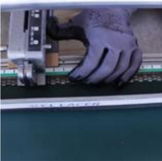
**11|** Bewegen Sie die Vorrichtung von Markierung zu Markierung. Am Ende ist der Verbinder geschlossen.
