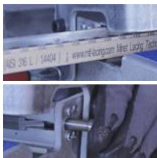
4| Den Verbinder auf den Kamm legen, der für den **Clip'N Lock®** geeignet ist. Fügen Sie den Pin ein. Entsperren Sie den Kammhalter, indem Sie die Schraube drücken. Legen Sie den entsprechenden Kamm ein.
