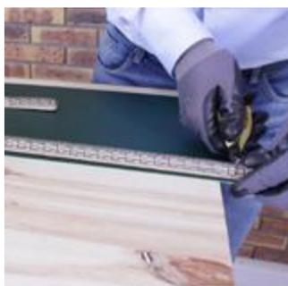
3| Schneiden Sie den Verbinder passend zur Breite des Gurtes. Denken Sie daran, den Verbinder auf dem Band pro Seite 3-5mm Luft zu lassen.
